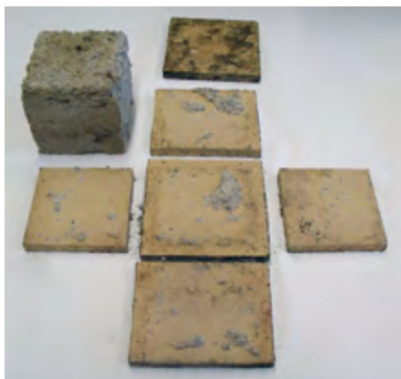
Spanplattenwürfel: Oben Steinwolle-Dämmung und unten Zellulosedämmung 30 Tage nach Feuchteeinwirkung / Quelle: Schimmelpilzwachstum auf Holz und Holzwerkstoffen; Michael Gomm; FH Kärnten Diplomarbeit;
