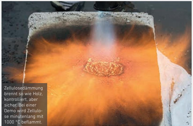
Zellulosedämmung brennt so wie Holz, kontrolliert, aber sicher. Bei einer Demo wird Zellulose minutenlang mit 1000 °C beflammt.
